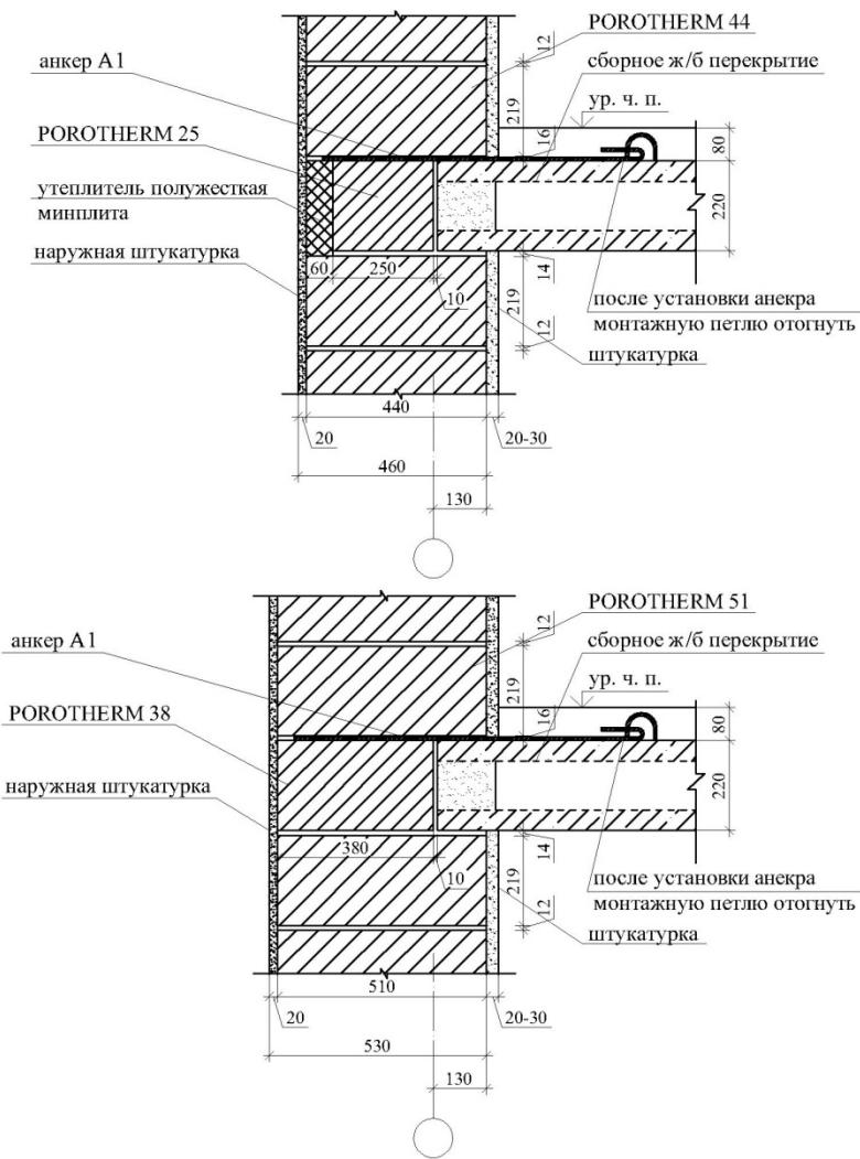
**Примечание:** В месте опирания сборной плиты перекрытия укладывается сетка Ø3 В1 оцинкованная. Сетку продлить в кладку на 20d.
