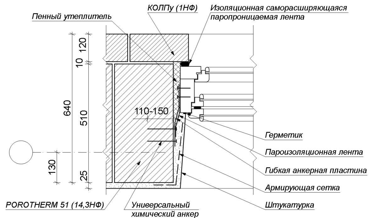
**18. Устройство сборных ж/б перемычек.**
