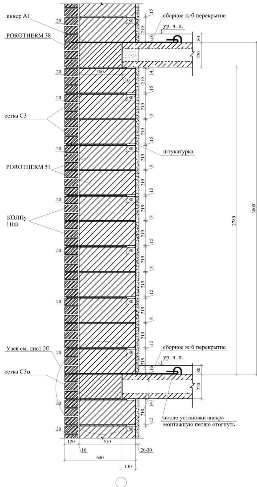
Сборная ж/б плита перекрытия. Высота этажа 3,0 м.
