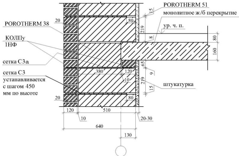
**9.3. Монолитная ж/б плита перекрытия.****Высота этажа 3,0 и 3,3м.****(Вариант 2).**
