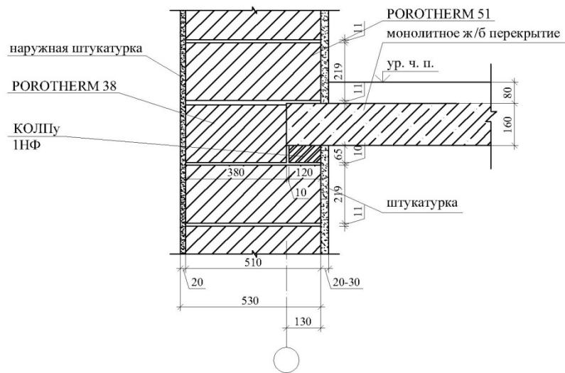
**10.3. Монолитная ж/б плита перекрытия.**
