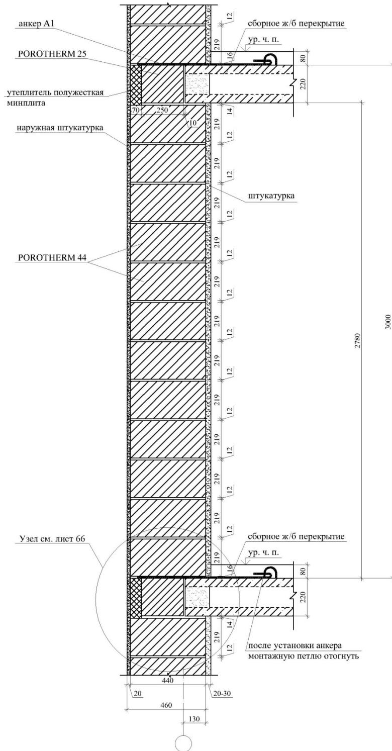
Примечание: В месте опирания сборной плиты перекрытия укладывается сетка Ø3 В1 оцинкованная. Сетку продлить в кладку на 20d.
