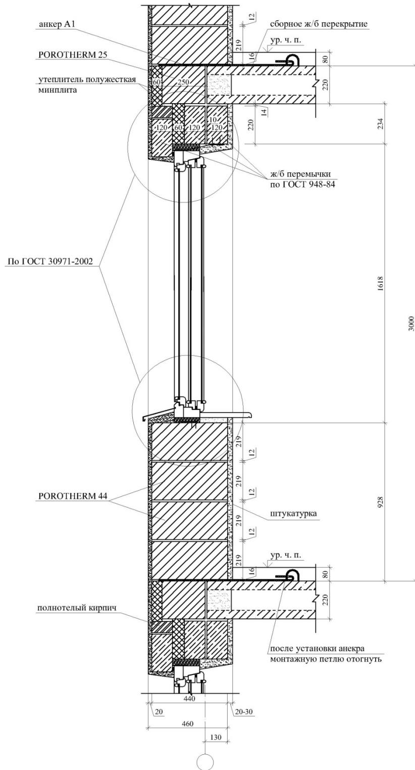
**Примечание:** В месте опирания сборной плиты перекрытия укладывается сетка Ø3 В1 оцинкованная. Сетку продлить в кладку на 20d.
