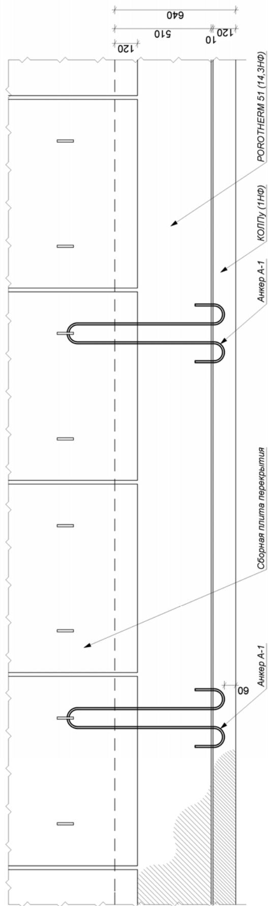
1. Анкер А-1 Ø10 Вр-1 устанавливать в раствор в местах опирания плит перекрытия.
