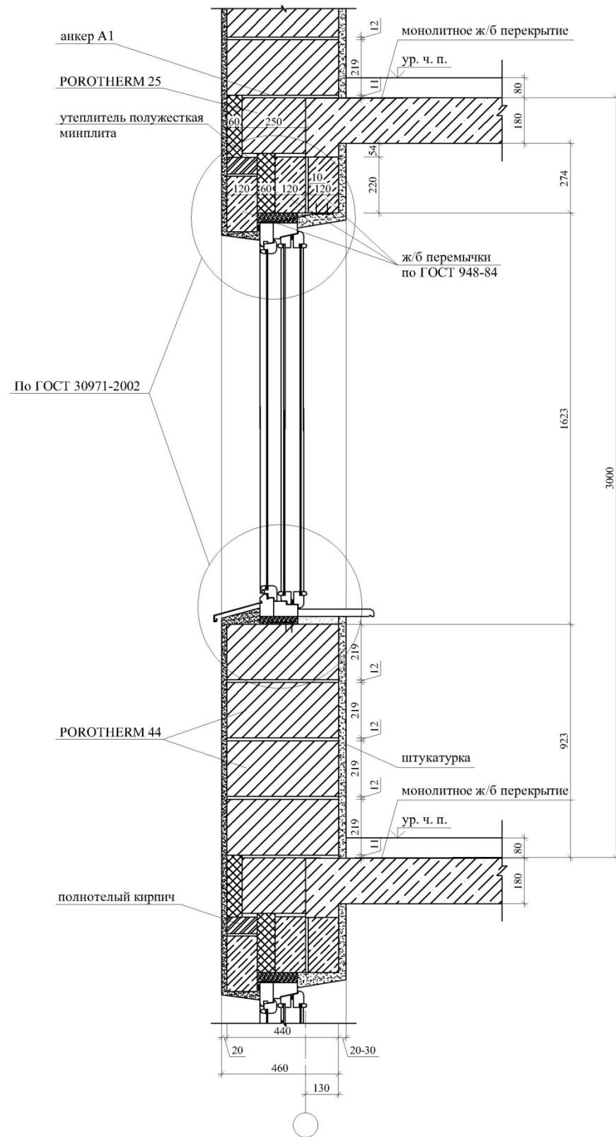
Монолитная ж/б плита перекрытия. Высота этажа 3,0 м.
